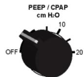
Control PEEP/CPAP, calibrado, rango de 0 a 20 cm de H<sub>2</sub>O
