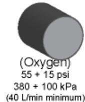
Entrada de gas impulsor (oxígeno), conexión DISS, requiere 55 + 15 psi (380 + 100 kPa), (40 litros/minuto mínimo)
